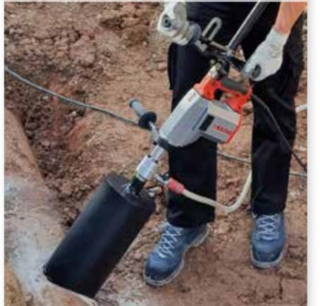
Kompaktes, leichtes Bohrsystem für kräfteschonendes Arbeiten, z.B. im Kanal. Der manuelle Vorschub wird durch das Handrad und die durchgängige Vorschubstange erzeugt.
