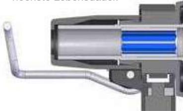
Mit sechs Auflageflächen wird der Halt des Meißels verstärkt und der Verschleiß reduziert.
